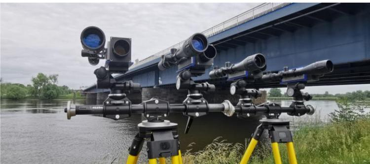
Mobiles Lasersystem für dynamische Belastungstests
